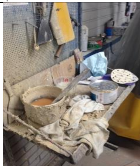
Schadeherstel: plamuur, mes en reiniger
